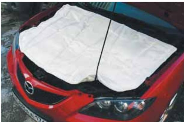
**6** Утеплить моторный отсек, чтобы в морозы сберечь тепло. Есть варианты установки изоляции на сам капот (с его внутренней стороны), но чаще для таких целей просто закрывают двигатель сверху и перед радиатором, обычно самостоятельно и подручными средствами. Дело нужное, поскольку сокращает время прогрева, способствует стабильному температурному режиму во время движения и сохранению тепла во время остановки и стоянки. А это дополнительный комфорт, экономия топлива и ресурса двигателя.
