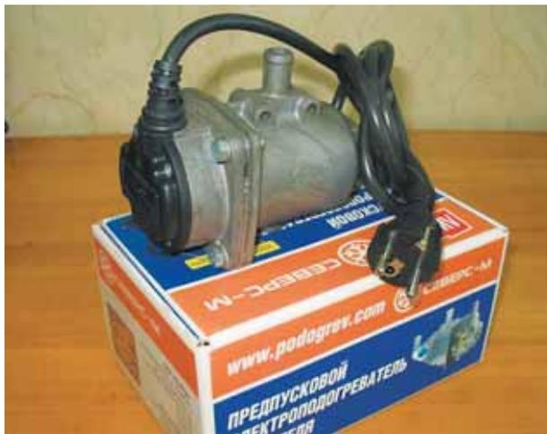
Подогреватели нового поколения **Северс-М** (или его аналог **Старт-М**) имеют горизонтальное исполнение нагревательной камеры, шариковый клапан для улучшения циркуляции ОЖ, терморегулятор и дополнительно аварийный выключатель. Однако более сложная конструкция не гарантирует высокую надежность устройства, плюс увеличенные размеры, что ограничивает применение в отношении иномарок. Цены от **2100** рублей, установка от **1500** рублей.
