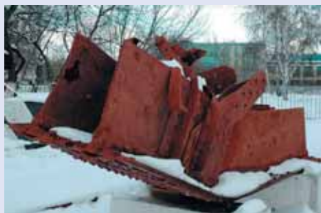
Это гражданской войны. В 1919-1920-х годах на нашем участке Транссиба отступающими белогвардейцами было взорвано пять мостов. Этот фрагмент стального клепаного моста постройки 1897 года со следами повреждений от взрыва был поднят в 2010-м году со дна реки Ия
