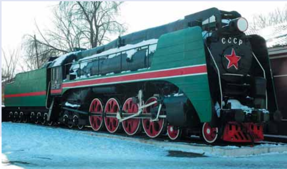
Паровоз последней советской серии П36 воплощал все передовые технические и дизайнерские решения. Его ведущие колеса диаметром 1,85 метра были самыми большими на тот момент. Памятник установлен на территории депо Иркутск-сортировочный
