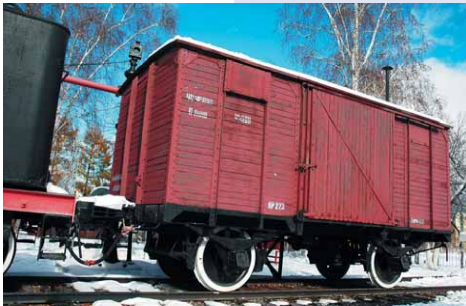
Самый распространенный в первой половине XX века товарный двухосный вагон. Однако начиная с периода переселения в начале XX века, был также приспособлен для перевозки людей и получил название вагон-теплушка
