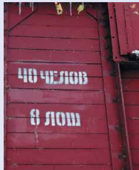
Самый распространенный в первой половине XX века товарный двухосный вагон. Однако начиная с периода переселения в начале XX века, был также приспособлен для перевозки людей и получил название вагон-теплушка
