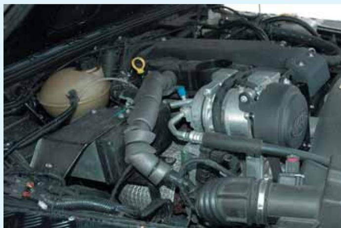
Под капотом современных автомобилей все трудней найти место для установки топливного подогревателя (на фото виден слева под пластиной), поэтому появились более компактные и модульные варианты
