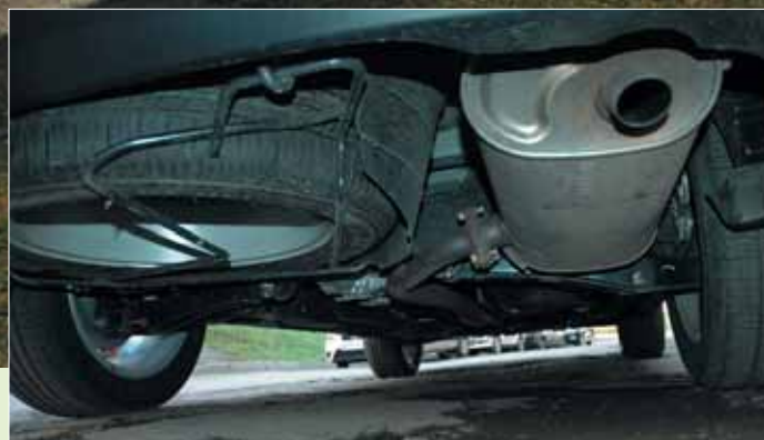
Запасное колесо осталось на родном месте, то есть под задним свесом
