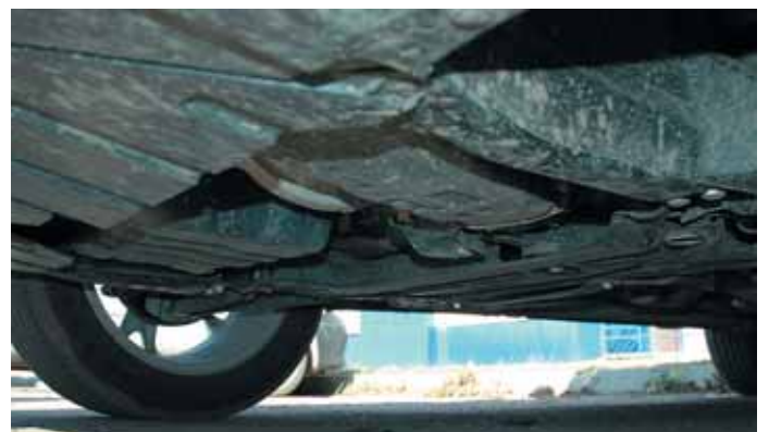
Моторный отсек снизу прикрыт пластиком и только частично, но поддоны двигателя и коробки расположены выше балки «подрамника», плюс клиренс в 215 мм, и это дает определенную защиту на бездорожье
