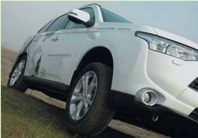
Короткоходная подвеска (переднее колесо уже в воздухе) указывает, что новый Outlander все же остался кроссовером
