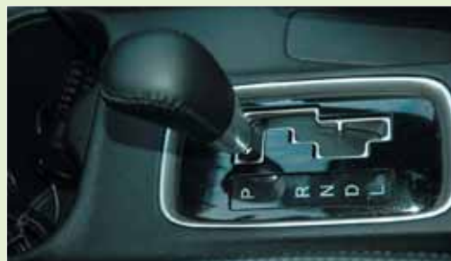
Ручной режим вариатора главным рычагом не включить — эта функция полностью перенесена на подрулевые лепестки
