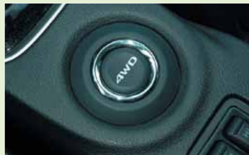
Теперь режимы трансмиссии задействуются не круглым переключателем, а последовательным нажатием кнопки
