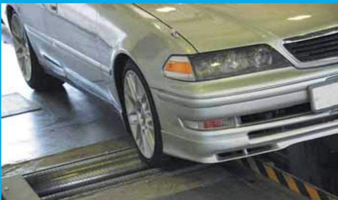
Тормозной стенд диагностирует эффективность работы тормозов и позволяет владельцу увидеть, насколько хороши тормоза его автомобиля
