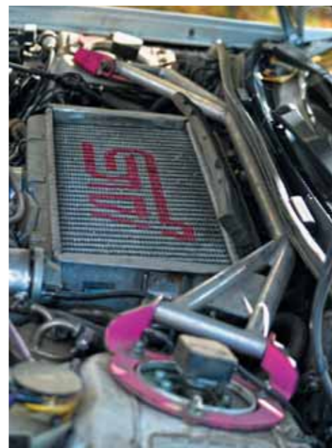
Под капотом — лишь одна из распорок. На благо жесткости кузова в этом проекте не попустились: пара верхних распорок — спереди и сзади, плюс нижняя распорка редуктора, а также передний подрамник от Cosco
