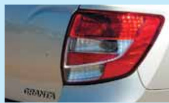
Секция света заднего хода есть только в правом фонаре. В левом на этом месте скрывается противотуманка
