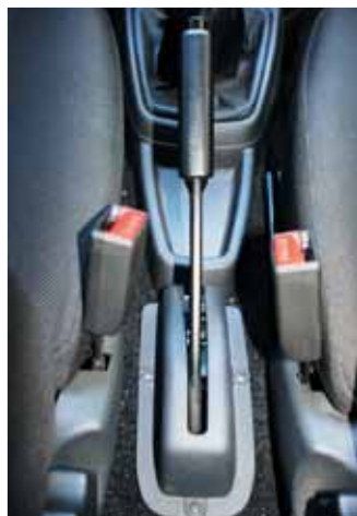
Рычаг ручного тормоза без изменений перекочевал в Гранту с классических Жигулей, и выглядит архаично даже в бюджетном интерьере
