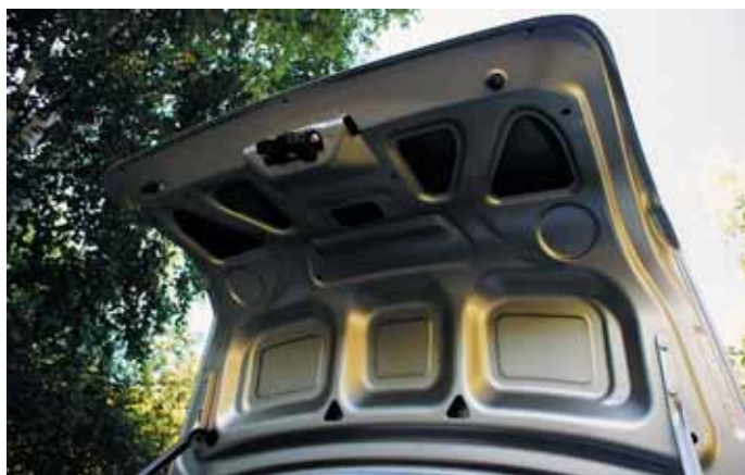
Внутренняя отделка крышки багажника в целях экономии не предусмотрена. Ручки для закрывания тоже нет — только выштамповки в каркасе
