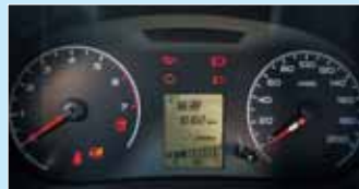
Приборная панель, не имеющая указателя температуры двигателя, проста и незатейлива, однако ее показания читаются без проблем
