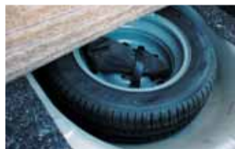
Полноразмерная запаска лежит под полом багажника, где она не пачкается. Однако при объемной поклаже достать ее будет проблематично
