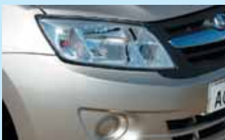
В больших блок-фарах штатно предусмотрена секция дневного света, который включается автоматически с запуском двигателя
