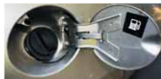
Лючок бензобака почему-то незапирающийся. Нет замка и на пробке, которую при заправке приходится оставлять висеть на «штурке»
