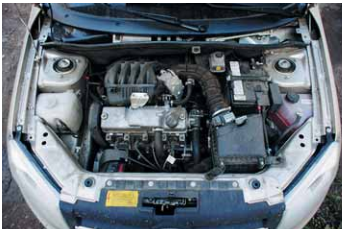
1,6-литровый 8-клапанник специально для Гранты модернизировали (облегчена шатуно-поршневая группа) и сделали мощнее
