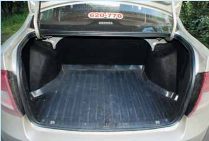
Огромный 500-литровый багажник Гранты отличается большим проемом. Но крючков или отсеков для принадлежностей здесь нет
