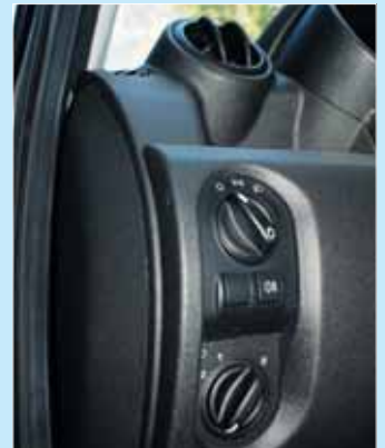
Фары включаются подсвечивающимся в темноте барашком слева от руля. Ниже — барашек корректора фар, а под ним — кнопка отпирания багажника
