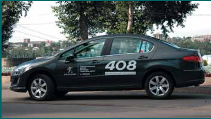
Клиренс составляет внушительные 175 мм с колесами на 16 дюймов (как в данном случае), а с 17-дюймовыми будет еще больше – 178 мм
