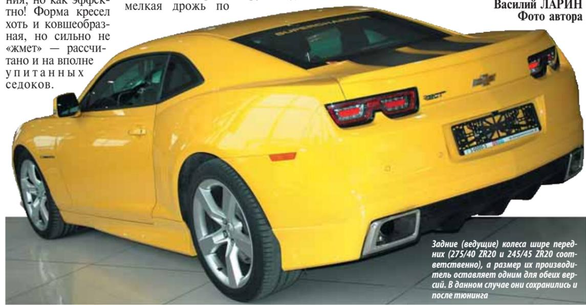
Задние (ведущие) колеса шире передних (275/40 ZR20 и 245/45 ZR20 соответственно), а размер их производитель оставляет одним для обеих версий. В данном случае они сохранились и после тюнинга
