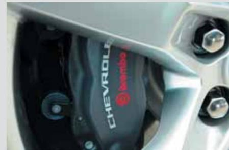
Тормоза Brembo с 4-поршневыми суппортами впереди — привилегия именно топовых версий 2SS с 6,2-литровым двигателем. На менее мощной версии тормоза ставятся обычные
