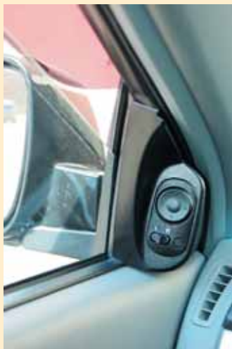
Управление приводами зеркал выполнено своеобразно. Сами же зеркала стали крупнее по сравнению с версиями для внутреннего рынка, и у них есть подогрев
