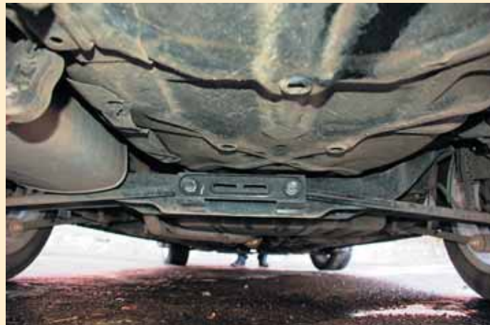
Сзади — независимая подвеска. Таковую теперь встретишь нечасто
