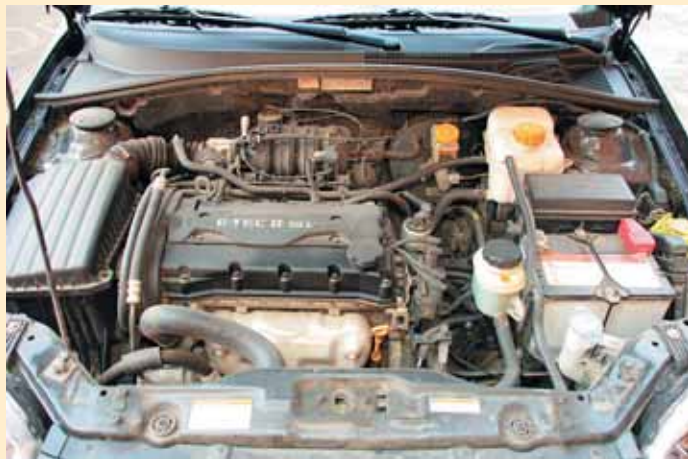
1,4-литровый двигатель хорошо вытягивает с низов, и по своей сути — святая простота. Никаких систем изменения фаз, непосредственного впрыска и других современных чудес. При этом восстанавливается! Только не прикрыв от грязи снизу — лучше сразу приобрести пластиковую или металлическую защиту
