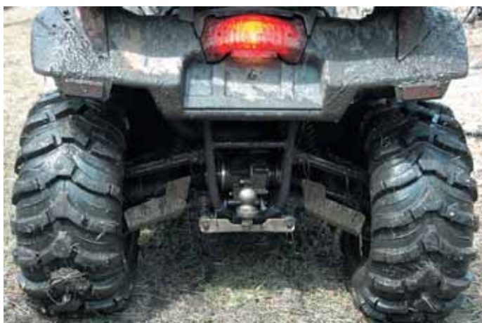
Независимая подвеска, большой клиренс, грязевая резина – базовые элементы для многих ATV. Защита картеров и рычагов во многих случаях идут как опция. А некоторые модели квадров оснащены механически регулируемой по жесткости стойками
