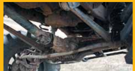
Такой изгиб для крестовины «шишиги», в отличие от большинства «японцев» — критический. А ведь мост еще и гуляет, нужно его разворачивать
