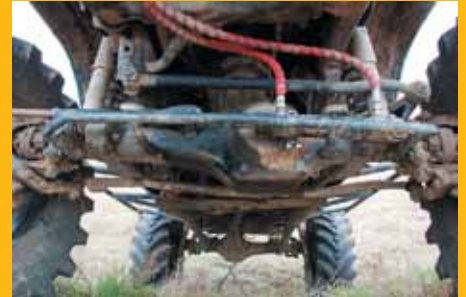
Под картером моста при 42-х колесах – 460 мм дорожного просвета
