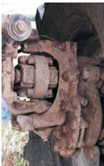
Внешний вид поворотного кулака и кардана не вызывает сомнений в их надежности. Что важно, у мостов Unimog в этом сочленении нет элементов, которые нужно было бы прикрывать резиновым пыльником
