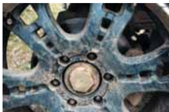
Дисковые тормоза — на всех колесах, мосты переделаны под 6 шпилек, колесные диски заказывались сплюсванным вылетом
