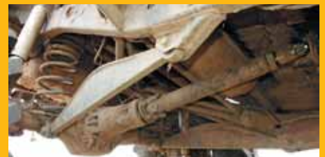
Задние продольные рычаги изогнуты и усилены. Держать им мост помогает А-образный верхний рычаг, играющий роль и тяги Панара
