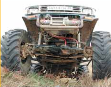
Гидроцилиндр подбирался по принципу «из того, что было». Выход только на одну сторону, из-за этого, не исключено, будет меняться
