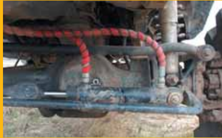
Гидроцилиндр подбирался по принципу «из того, что было». Выход только на одну сторону, из-за этого, не исключено, будет меняться
