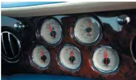
Стрелочные часы размещены в одном «блоке» с приборами, которые включают указатели напряжения и давление масла, шкала температуры двигателя размечена по Фаренгейту
