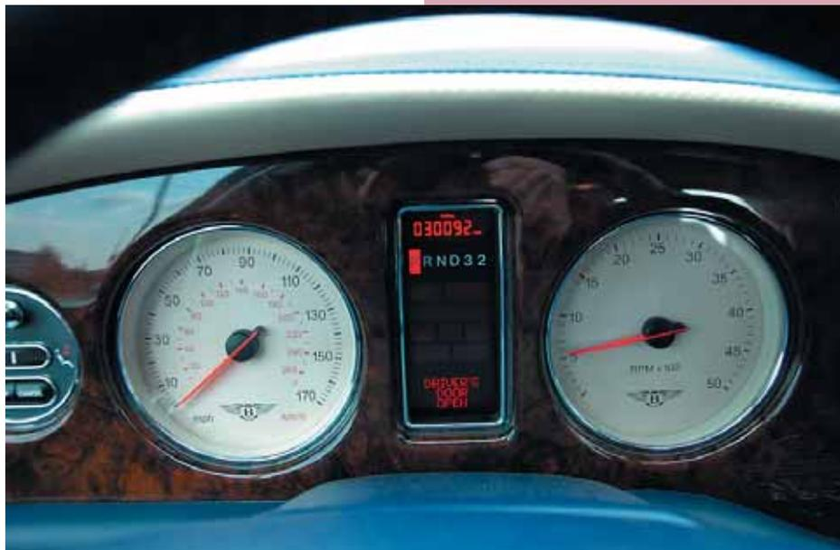
Стистика аналоговых приборов скромна и одновременно изыскана, хотя есть и электронный дисплей. Спидометр размечен по двум системам измерения скорости, а тахометр размечен двузначными и не очень большими цифрами — для низкоротного двигателя красная метка поставлена уже на 4500 оборотах
