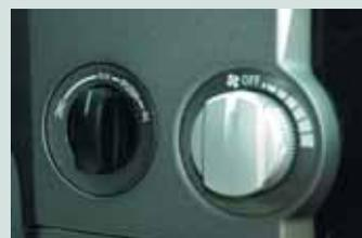
Подключаемый передний привод и понижающая передача входят в стандартную комплектацию. Управление ими осуществляется вращающейся ручкой
