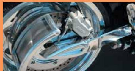
Передние тормоза 2-дисковые 296 мм с 3-поршневыми суппортами, задние — один диск 316 мм с 2-поршневым суппортом
