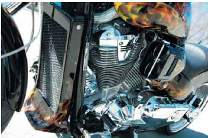
*Радиатор охлаждения штатный, а вот его обрамление — ручная работа. Сам двигатель в дополнительной красоте вроде как не нуждается, при жидкостном охлаждении имеет и обязательные по стилистике ребра, а чтобы не снижать визуальное впечатление и в темное время, оснащен подсветкой*
