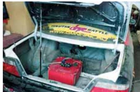
Выносной топливный бак на 25 литров в багажнике
