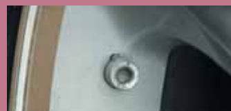
Это своеобразная альтернатива бэдлокам – вкрученные по периметру диска болты удерживают закраину шины на хампе, предотвращая разболтанные колеса
