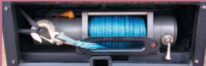
Передняя лебедка целиком спрятана внутри бампера. Квадратная часть предназначена для «парковки» моторной лодки — пожелание владельца
