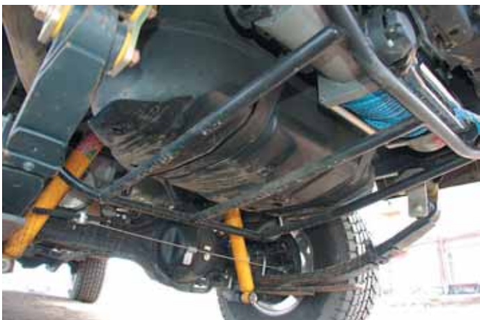
Объемный бак защищен каркасом из труб. Понравилось, как компактно под бампером установлена лебедка. Мост, судя по размерам картера, имеет главную пару диаметром 9,5 дюймов. Но колеса его уже, чем у переднего: от чего заимствовали? Пришлось на ступицах устроить 40-мм проставки
