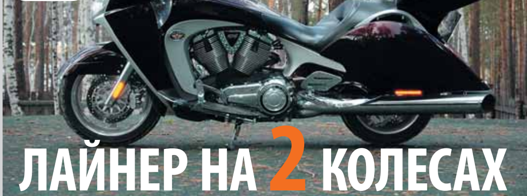
Передние тормоза двухдисковые 4-поршневые, задние однодисковые 2-поршневые, все диаметром 300 мм и оснащены ABS
