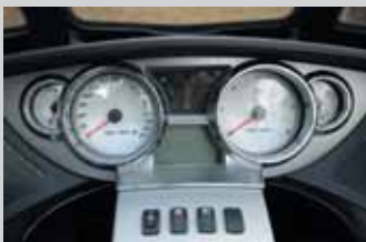
Даже по стилистике и своим значениям шкалы настраивают на вальяжный драйв. Обратите внимание на малооборотный характер двигателя – тахометр размечен всего до 6000 оборотов с красной зоной от 5000
