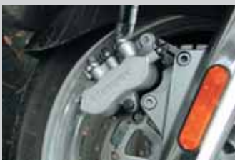
Передние тормоза двухдисковые 4-поршневые, задние однодисковые 2-поршневые, все диаметром 300 мм и оснащены ABS
