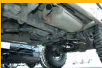
Интеграция агрегатов LC 78 в раму УАЗа обошлась без anomalies: выход на передний мост с нужной стороны, поддоны не «висят», а необходимость «прибавить» боди-лифт только на общую пользу
