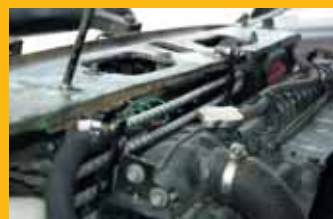
Вот он, апогей 6-летнего тюнинг-марафона — установка 3,0-литрового 130-сильного турбодизеля 1KZ-TE и АКП. Радиатор от LC-80, а последним действом стали радиатор ГУРа — виден его «змеи-вик» сверху, и «отовый» радиатор АКП (размещен ниже). Кроме того, на всякий случай в ЗИПе «Глухаря» появился запасной стартер
