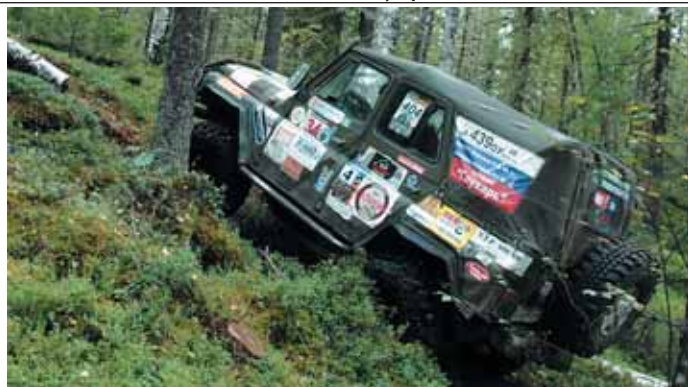
Август 2010-го. Рейд Торы-Шаманка. «Глухарь» уже на 36-х Simex, стюнигованной до 1:3 раздаткой, японским ГУР-ом и другими доработками. Подвеска до сих пор остается рессорной, что, в частности, имеет свои преимущества на косогорах, однако новые реалии требуют ее модернизации на пружинную
