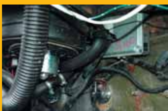
Вместо стандартного установлен более эффективный отопитель НАМИ, но со стороны штурмана также разместился процессор дизеля и корабельный выключатель массы
