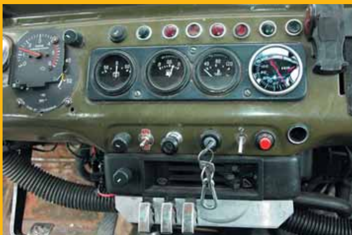
Уникальная комбинация приборов: УАЗовские датчики, «Прадовский» тахометр, «модный» указатель температуры масла АКП (установлен дополнительно) и все стандартные сигнальные лампочки, предусмотренные японской электросхемой
