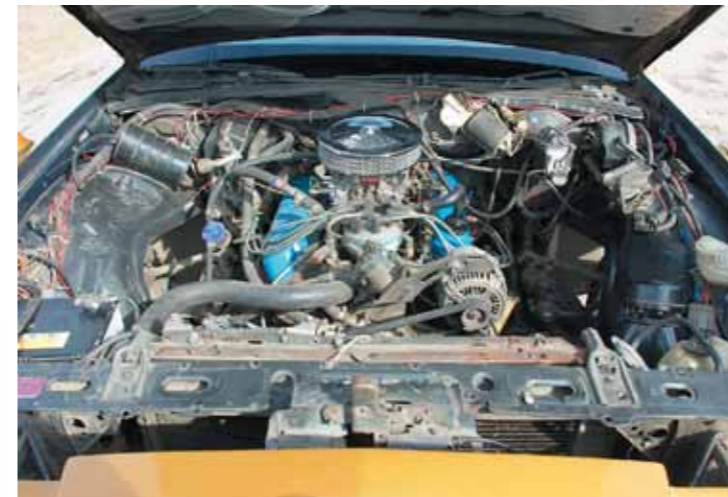
Еще до покупки в 2005 году двигатель прошел через капитальный ремонт. Удивительно, однако пятилитровая «восьмерка» Windsor восстанавливалась с использованием газовских запчастей. Уже нынешним владельцам пришлось ремонтировать стартер, менять насос гидросилителя и помпу. Что-то заказывается из Америки, но многое можно найти по «образу и подобию». Например, щетки для стартера подошли от узловского узла, а сальниками делятся «японцы». Еще бы клапанные крышки и выпускной коллектор поменять – на полированные от Edelbrock
