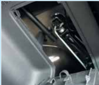
Домкрат и баллонный ключ находятся в правой нише багажника и практически всегда легкодоступны
