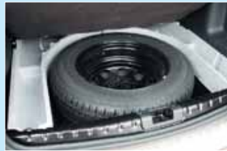
На полноприводных машинах полноразмерная запаска лежит под полом в багажнике и не пачкается. Завышенный уровень пола в багажнике отчасти компенсируется наличием пластикового органайзера для аксессуаров и принадлежностей
