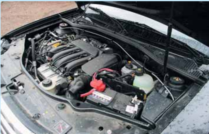
2,0-литровый бензиновый мотор Duster под капотом расположился достаточно плотно. Однако обслуживанию это практически не мешает, а вопрос ремонта владельца, скорее всего, не затронет: на других моделях Renault к этим двигателям серьезных претензий нет
