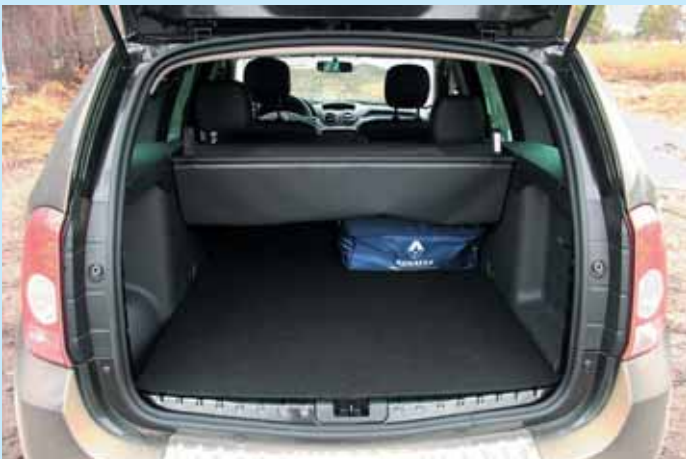
Главный плюс багажника Duster – ровный пол и отсутствие выпирающих внутрь колесных арок. Есть и мягкая шторка – но, увы, не сворачивающаяся
