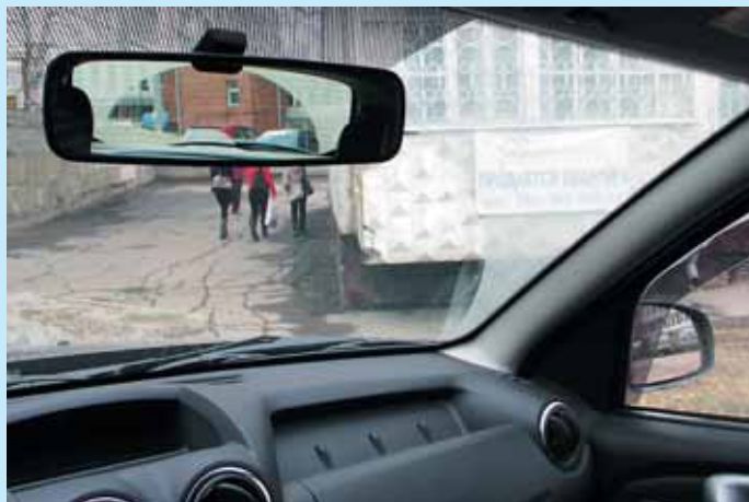
Обзор во внутрисалонное зеркало неплохой. А вот наружные зеркала могли бы быть и покрупнее. К тому же часть обзора в них скрывается за опциональными ветровиками
