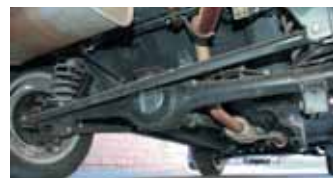
Цельный мост сзади уже почти исчезнувший атрибут. Во всяком случае, на одинаковых по размерам да и более крупных кроссоверах он не встречается давно. Между тем, на бездорожье это элемент, повышающий «живучесть»
