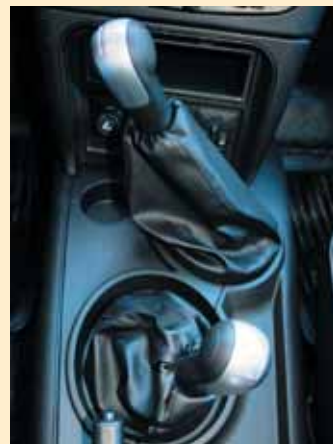
Рычаг раздаточной коробки ведет себя лучше, чем, например, на UAZ Patriot. То есть легко «входит и выходит». А вот избирательность рычага «механики» ужасная
