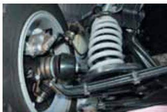
Передняя двухрычажная подвеска на неровных покрытиях в теории должна вести себя лучше, чем McPherson. У Niva она отличается еще и энергоемкостью
