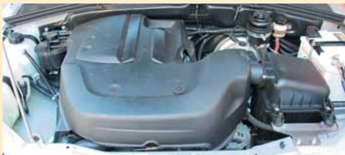
Двигатель 2123 получен из мотора 21214 – что-то по навесному изменено, крепления. Блок и поршневая группа идентичны. К сожалению, с ним Chevrolet Niva по динамике – автомобиль из середины прошлого века. Зато расход топлива в пределах разумного – 10-11 л/100 км на трассе и в городе
