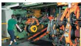
Шиносборочная машина. Все меньше и меньше на них ручного труда
