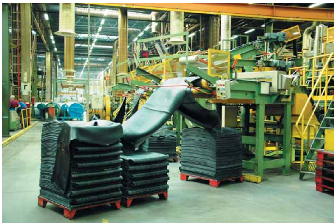
Вот оно, начало производства шины — конвейер медленно, словно удав кролика, заглатывает «сырую» резиновую ленту, из которой через несколько технологических стадий с вулканизацией в финале «выкатится» готовая покрышка
