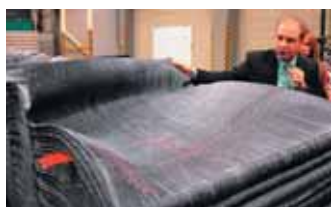
Рецепт резиновых смесей «прост» — сажа и каучук нужного качества и в нужных пропорциях плюс секретные ноу-хау
