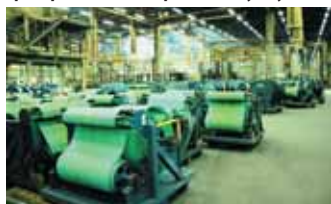
Некоторые цеха шинного завода напоминают ткацкое производство — в данном случае это один из компонентов для изготовления кордов
