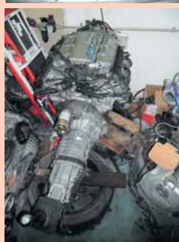
А вот и итог — развернутый J32A в сборе с W58
