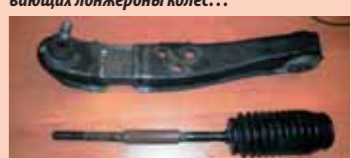
Вслед за этим на 5 см пришлось удлинить рычаги и рулевые тяги
