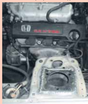
Опоры передних стоек перенесли из-за задевающих лонжероны колес...
