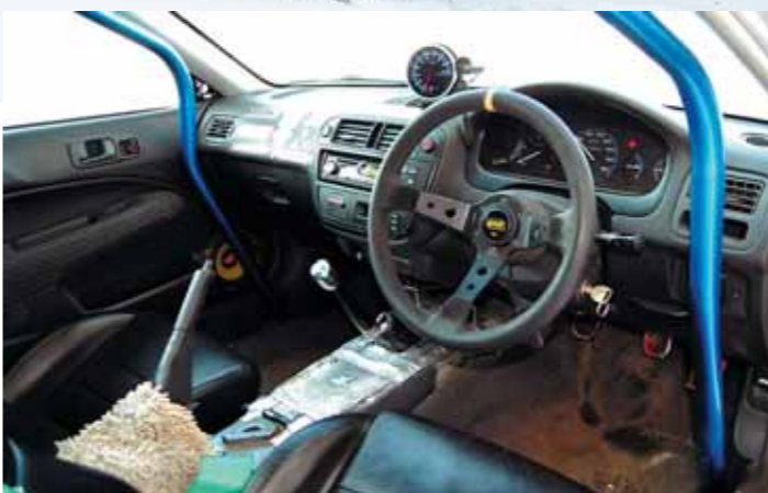
Все внедренные в начинку инженерные решения отполированы содержимым кокпита: сиденья от S2000, руль Nardi, каркас безопасности Cusco, ремни Takata и тахометр — ничего лишнего
