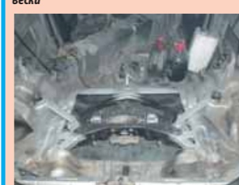
Задний подрамник теперь и вовсе выполняет роль несущего элемента кузова — для его «упаковки» лонжероны пришлось немного порезать, а сам подрамник жестко вварить в кузов
