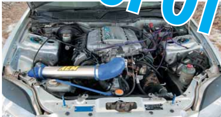
Под капотом многое найдется совсем не в тех местах, где ему положено быть. Как собственно, и само положение мотора: продольный J32A — такое встретишь не каждый день...
