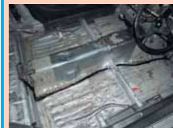
Под новую трансмиссию пришлось менять и центральный тоннель в полу: родной был вырезан, а на его место встал аналог от Nissan Cefiro A31 — как будто здесь всю жизнь и стоял. Доработке сваркой подверглась и ручка КПП — при установке коробки оказалось, что она располагается слишком близко к центральной консоли
