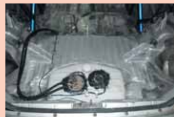
Под новую трансмиссию пришлось менять и центральный тоннель в полу: родной был вырезан, а на его место встал аналог от Nissan Cefiro A31 — как будто здесь всю жизнь и стоял. Доработке сваркой подверглась и ручка КПП — при установке коробки оказалось, что она располагается слишком близко к центральной консоли
