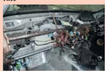
Родная печка Civic'a после свапа не подошла — для нее был изготовлен новый корпус с радиатором, воздуховоды Владислав развел нейлоновой армированной гофрой
