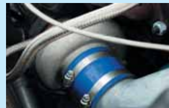
Две среды применения – два турбо-кита. Коллекторы к ним прокладывались так, чтобы максимально сократить расстояние от места забора воздуха до турбины
