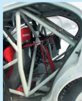
Каркас (естественно, омологированный) Степан изготавливал в своем «ателье» PowerTech – цельнотянутые трубы и трубогиб плюс рафовские стандарты
