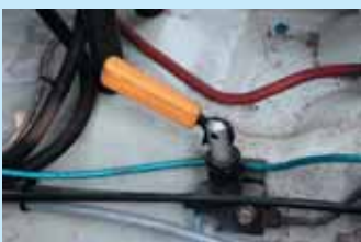
С низкой эффективностью задних тормозов пришлось бороться, в том числе установкой регулятора тормозных усилий. А вообще, что бывает редко в местном тюнинге, тормозная система претерпела более чем глобальные изменения
