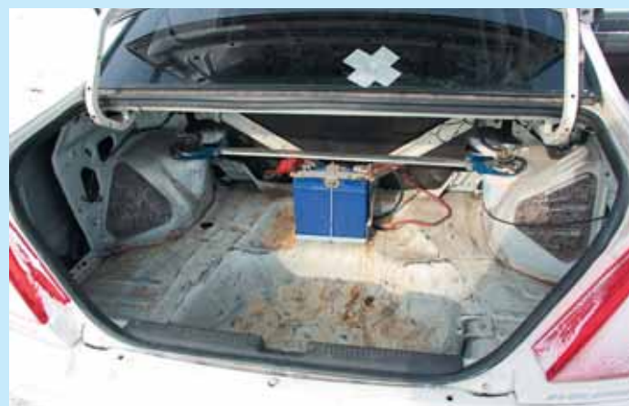
Из «гражданских» вещей осталась только передняя панель да обивка дверей. Все остальное удалено — боевой аппарат! Аккумулятор перенесен в багажник. Вместе с распорками жесткость подвески увеличивают стабилизаторы поперечной устойчивости Cusco с большим сечением прутка
