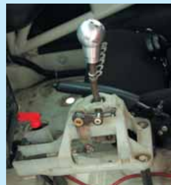
Рычаг коробки перенесен выше – в любых видах автомобильного спорта скорость переключения передач – важный элемент. К предстоящему сезону появится кулачковая коробка. Но трансмиссионные технологии в красноярском классе GT4 уже шагнули дальше – те же Seat'ы имеют «роботы» с переключением на руле
