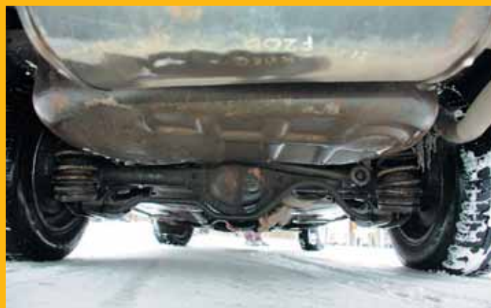
При многих новаторских решениях задний мост инженеры Volvo оставили цельным. К нему плохо подходят пружины от универсала Volvo 245 и амортизаторы от грузовичка Nissan
