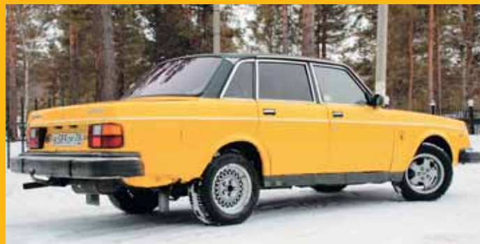
При многих новаторских решениях задний мост инженеры Volvo оставили цельным. К нему плохо подходят пружины от универсала Volvo 245 и амортизаторы от грузовичка Nissan
