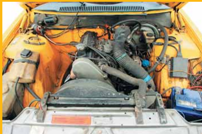
Одновальная 2,3-литровая «четверка» — живой агрегат. И хорошо тянущий почти с холостых оборотов. Обратите внимание — поставлен под наклоном
