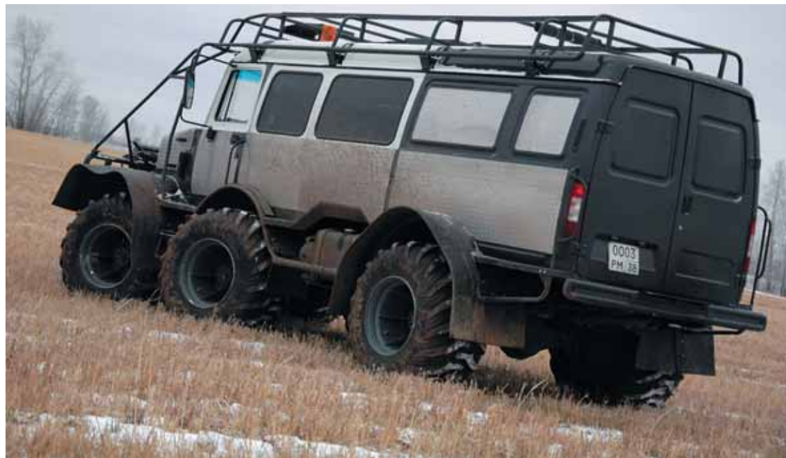
Шины и диски комплектованы от сельскохозяйственной техники, при этом колеса получили свою оригинальную доработку по усилению ободов
