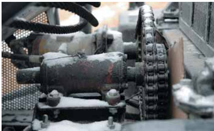
Гидравлический привод лебедки (насос на заднем плане) полностью оригинальной конструкции, с использованием системы цепных передач
