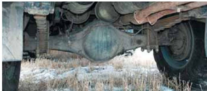
Пакеты рессор подбирались из расчета нормальной грузоподъемности и ездового комфорта. Клиренс с мостами ГАЗ не рекордный, но вполне так приличный
