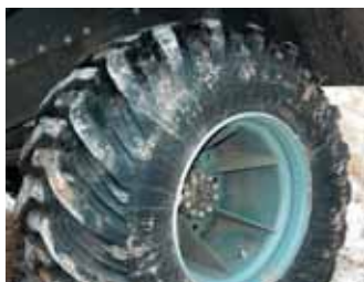
Шины и диски комплектованы от сельскохозяйственной техники, при этом колеса получили свою оригинальную доработку по усилению ободов
