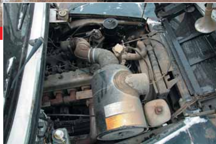
Установка рядного 7,0-литрового дизеля Nissan обошлась без «наращивания» капота по длине, отчего машина выглядит «коротконосой». Но главное, что для своей стихии ей хватает и динамики, и тяги
