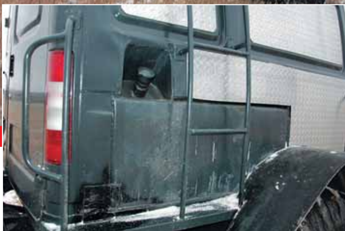
Большой (на 200 литров) самодельный бак удачно интегрирован в багажный отсек
