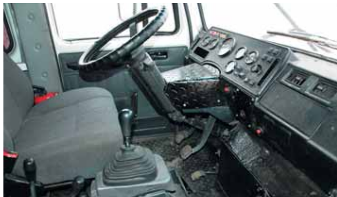
При внедрении «чужого» двигателя и коробки в кабине ГАЗ удалось сохранить «родной простор», хотя часть рычагов сложной трансмиссии расположились немного дальше обычного
