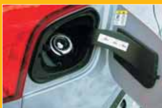
Бензобак не имеет отдельной пробки: ее роль исполняют клапан в горловине и внешняя крышка, запираемая вместе с дверями центральным замком
