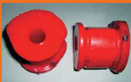
Все элементы подвески заменены: новые изготовлены из твердокаменного 80-го полиуретана. Из этого же материала и подушки двигателя. А вот сайлентблоки заднего моста в этой GTO и вовсе стальные
