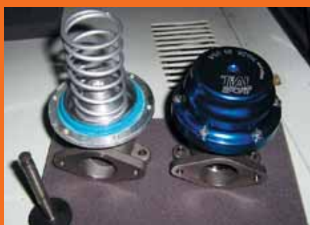
Вестгейты у GTO установлены внешние от Tial с пружинами на 1 бар
