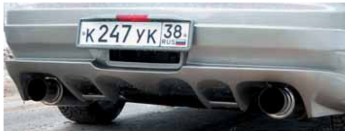
Алексею Грошеву GTO досталась с весьма потрепанным жизнью 3,5-дюймовым титановым выхлопом — изрядно помятым, побитым и провисающим над землей. Эту конструкцию новый владелец удалил, установив взамен новый 3-дюймовый тракт с логическим завершением в виде резонатора Fox и двух «банок» Autobahn88
