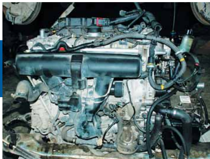
АКПП Aisin на Volvo XC90 снимается только вместе с двигателем и имеет достаточно проблем. Ее американскую альтернативу можно демонтировать отдельно, однако с надежностью у той АКПП также не все в порядке
