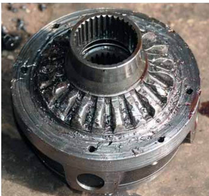
Для «автоматов» Aisin, которые устанавливаются на Toyota, все началось с коробки U140. В планетарной передаче срезало оси сателлитов и они, в свою очередь, довершили дело
