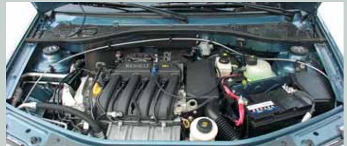
16-клапанный мотор – это мегановский K4M, дефорсированный до 102 сил. Но пик крутящего момента и мощности сдвинулись в сторону высоких оборотов – на низах этот двигатель тянет хуже
