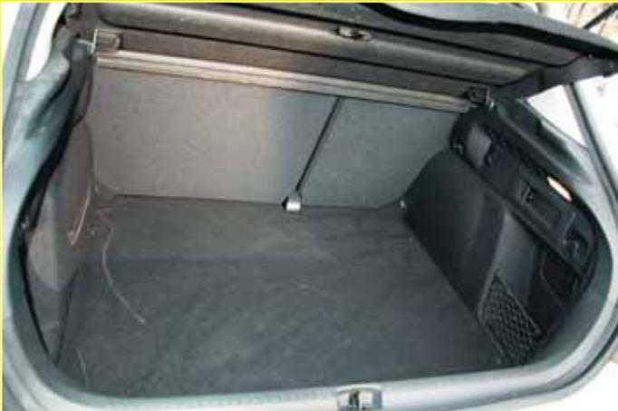
Багажник емкий, правильной формы, с карманами и крючками, под низким полом полноценная запаска и лоток с инструментом
