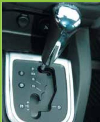
АКПП классическая 4-ступенчатая и склонна «тормозить», но имеет спортивный режим, зимний, и возможность ручного переключения передач
