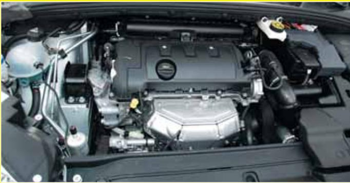
Предлагается пока единственный двигатель объемом 1,6 литра, но мощностью 120 сил и со штатной стальной защитой моторного отсека
