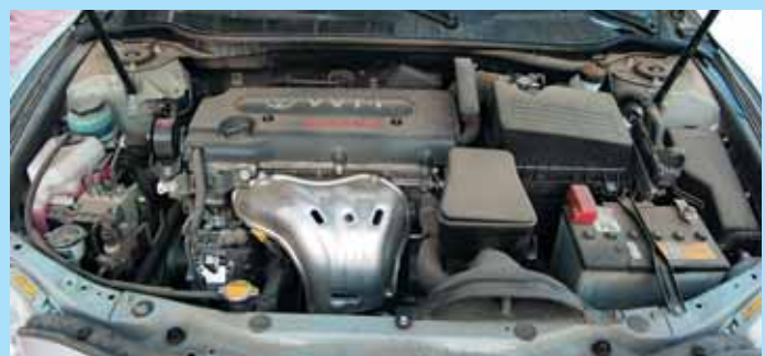
2,4-литровый 2AZ-FE — характерный представитель двигателей Toyota
