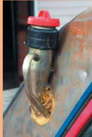
Горловина топливного бака вынесена наружу — на заднюю правую стойку кузова. Такое решение стало оптимальным при компоновке элементов топливной системы в задней части автомобиля
