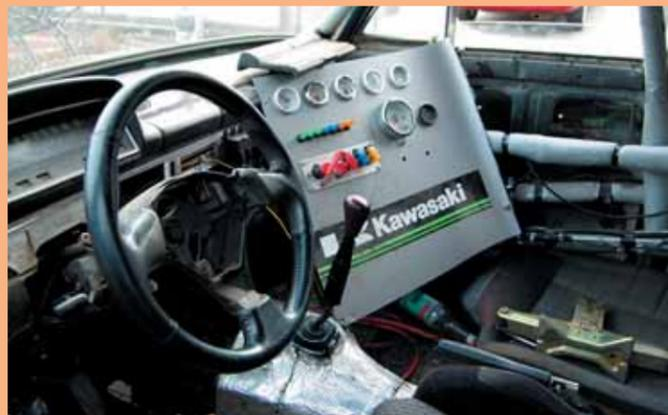
Аскетично. Спартакски. Зато все уместилось. С электрикой при свапе особо не заморачивались — все «замкнуто» напрямую. Процесс заводки напоминает запуск самолета — пробегая по многочисленным тумблерам, нажатие на «классическую» красную кнопку, и пространство вокруг содрогается от сочного звука выхлопа 3S-GTE
