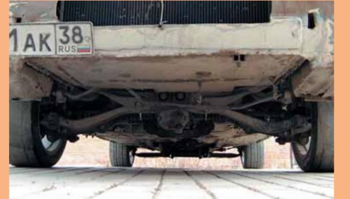
Подвеска автомобиля — одно из многочисленных нестандартных решений в этом уникальном проекте — донорами стали Impreza и Legacy B4. Для успешного размещения задней части ходовой кузов пришлось расширить на 15 см с каждой стороны
