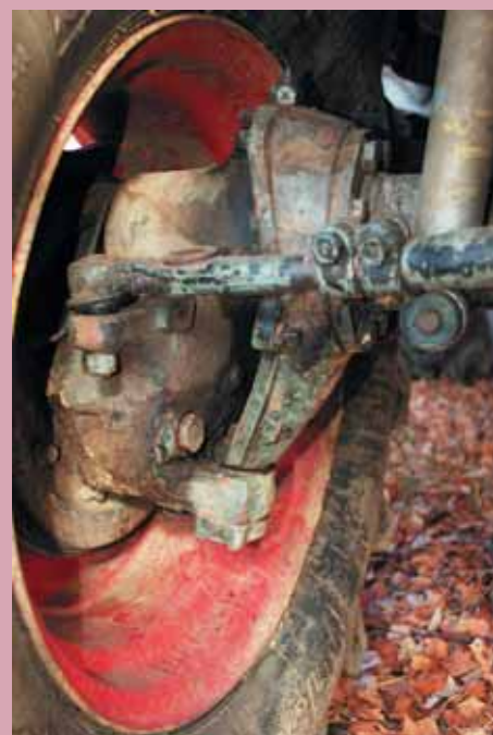
Между чулком моста и поворотным кулаком — пыльник, прикрывающий ШРУС. Он, в свою очередь, прикрыт металлическим рычагом. Чтобы повредить резинку, нужно постараться. Любопытно, что все запчасти к балкам доступны через Интернет-магазины. Цены, в общем-то, сопоставимы с тойотовскими
