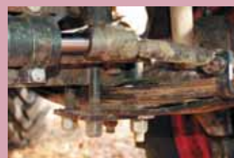
В стыковке поршней гидроцилиндра с вольвовскими тягами была определенная сложность — резьба на последних дюймовая. Стремянки рессор от КраЗа
