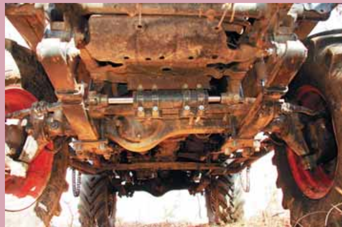
Денис Селезнев не стал городить мудреную подвеску — всего лишь рессоры да амортизаторы. Зато ломаться нечему
