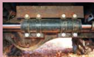
Гидроцилиндр обеспечивает 6 дюймов между крайними положениями поршней. Есть и 8-дюймовый, «прокачать» который штатным гидросилителем невозможно. Уголок сверху прикрывает шланги
