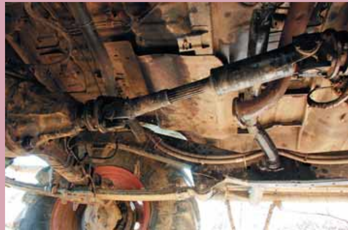
Задний кардан после переноса рессор вниз мостов приобрел достаточный для нормальной работы крестовин угол. Передний тоже, но там на всякий случай используется сдвоенная крестовина от Surf
