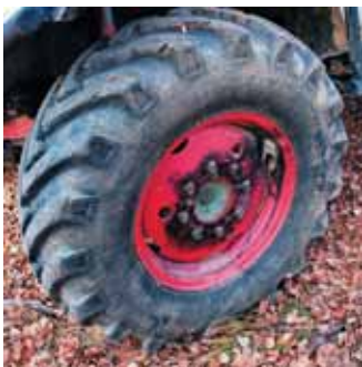
8-слойная Belshina размерностью 42x13,6-20 надета на диски от трактора МТЗ, в которых пришлось просверливать восемь отверстий под шпильки мостов. Колесо в сборе весит более 70 кг, и это не рекорд. Жаль, с гайками беда — подобрать открученные не удастся, резьба дюймовая
