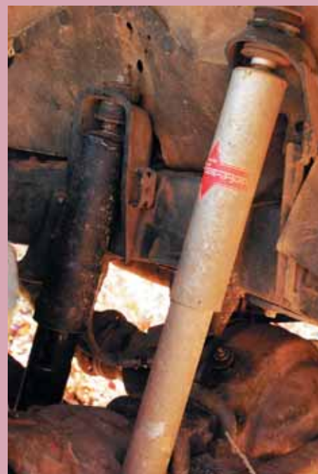
Спереди по два амортизатора — колебания значительных неподрессоренных масс нужно гасить
