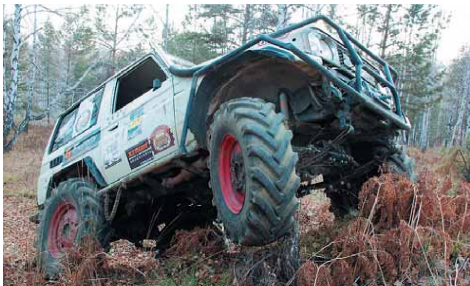
Ходы колес невелики — при штатных блокировках у шведского «портала» большая артикуляция мостов и не нужна
