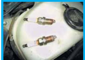
Состояние компонентов системы зажигания — в частности, свечей — прямо влияет на успех холодного запуска двигателя. Если есть сомнения в состоянии, или при длительном сроке службы, свечи перед зимой лучше поменять на новые
