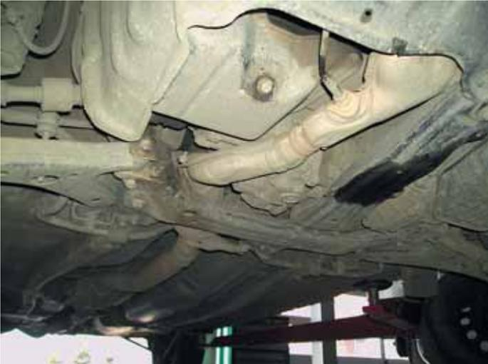
Перед зимой есть смысл заглянуть под машину: следы масла или иной жидкости требуют обязательного поиска их источника и устранения течи
