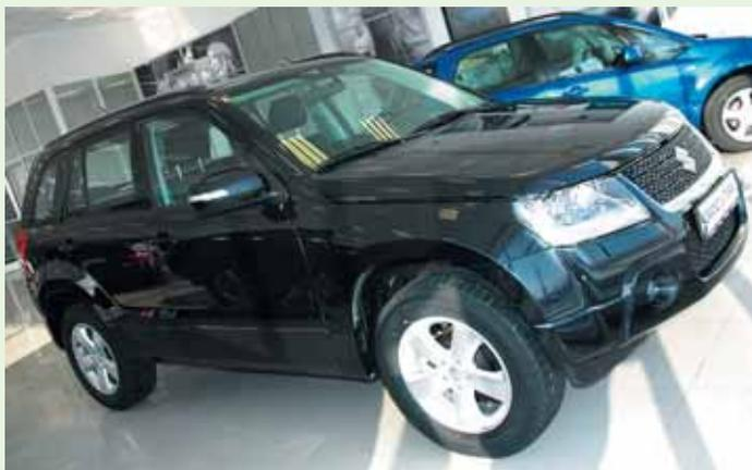
Suzuki Grand Vitara остается единственным кроссовером с традиционной схемой привода: продольный двигатель, постоянный полный привод и понижающая передача
