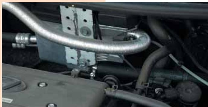
Установка рабочего блока топливного подогревателя, особенно в тесных условиях, зачастую требует нестандартных решений по его размещению и высокой квалификации мастера. В данном случае с наличием места все в порядке, но сама установка, причем проведенная в дилерском сервисном центре, удивляет небрежностью — взгляните на крепежную скобу! Прежде чем довериться установщику, узнайте, какой у него опыт работы с подогревателями, как он проводит послепродажное обслуживание и проводит ли его вообще
