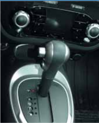
Контроллер вариатора вопреки моде бесхитробно «ходит» по прямой линии. Это правильно, хотя и есть вероятность промаха нужной позиции
