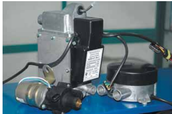
«Бинар» — российский топливный подогреватель, принцип работы как у того же Webasto, но отличается меньшей стоимостью и модульной конструкцией
