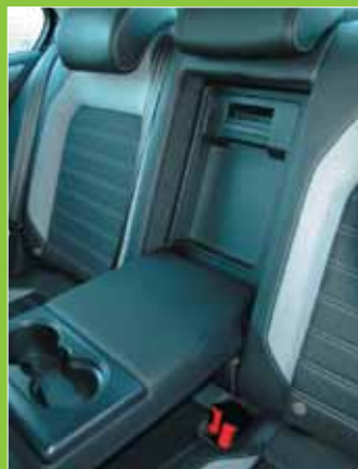
Спинка складывается по частям, но для узких длинномеров еще предусмотрен и лючок
