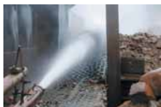
Прииск. Нынешняя технология «мойки» золота при помощи мощного гидромонитора. Породу к нему «подгребают» бульдозерами прямо из русла реки
