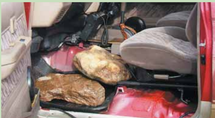
Для форсирования высокой воды с быстрым течением даже приходилось грузить балласт — так меньше вероятность «всплытия» и потери управляемости
