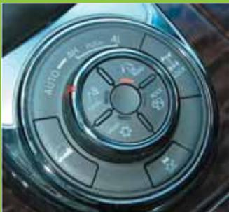
Селектор управления трансмиссией и режимами движения. Доступно множество вариантов: стандартный полный привод с автоматическим подключением переднего моста (от 0:100 до 50:50), постоянный полный привод, понижающий ряд передач, блокировка заднего дифференциала и выбор «дороги» (асфальт, песок, камни, снег). Можно задействовать систему помощи на уклонах, а также отключить систему курсовой устойчивости, чтобы «не мешала» на сложном бездорожье
