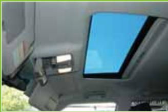
Небольшие размеры люка продиктованы усиленной конструкцией кузова. Сам люк с электроприводом, а вот штора двигается вручную!
