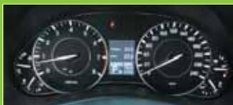
Приборы яркие, информативные, есть даже вольтметр и датчик давления масла. Компьютер показывает расход 25 литров на 100 км в городе, и это объективная реальность
