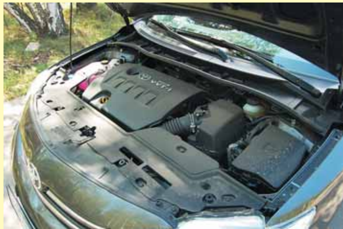
Новый 1ZR-FE получил большую в сравнении с предшественниками литровую мощность, фазовращатели на обоих распределах и, вероятно, те же проблемы. По крайней мере, конструктивно он не изменился
