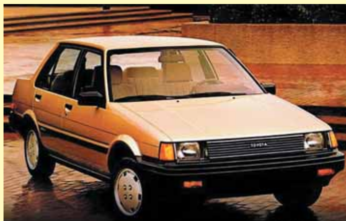
Corolla 1983-го стала переднеприводной. Двигателей было три (1,3-1,8 л), выпускалось купе GT с 16-клапанным 121-сильным мотором
