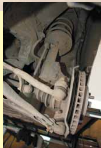
Спереди у McPherson, скорей всего, первыми разобьются втулки стабилизатора. Потом придется поменять амортизаторы. Ждать выхода из строя других деталей придется долго
