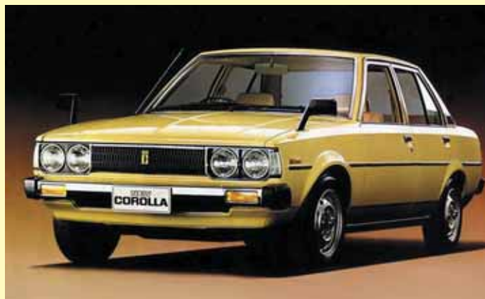
«Рубленая» Corolla четвертого поколения приобрела пружины в задней подвеске и «гидроусилитель»
