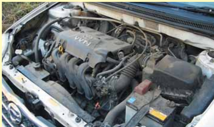
Двигатель 1NZ-FE устанавливался на огромное количество автомобилей Toyota вплоть до D-класса.
