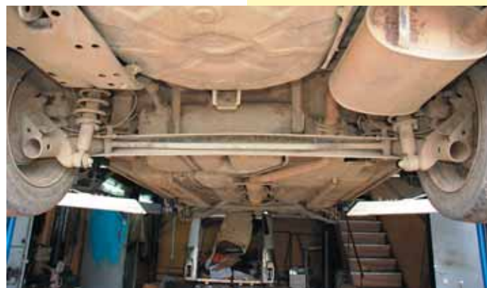
Езда под нагрузкой ведет к быстрому износу сайлент-блоков балки. Больше (кроме, пожалуй, амортизаторов) ломаться здесь нечему
