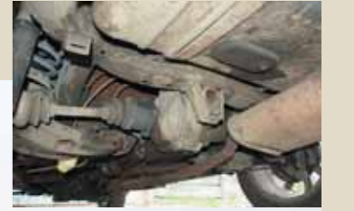
Задние рычаги и редуктор от Crown. Передние и задние тормоза — дисковые
