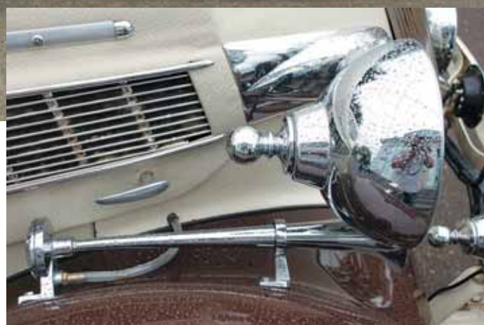
Карим не отказал себе в удовольствии оборудовать BMW дополнительной и хромированной оптикой, пневмосигналом, а также обшить створки капота винилом
