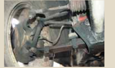
Передняя подвеска — образец примитивизма тех лет. В качестве нижнего рычага используется поперечная рессора. А верхний связан с рычажным амортизатором. Для хороших немецких автобанов сойдет, но в России хочется чего-то покрепче, современнее
