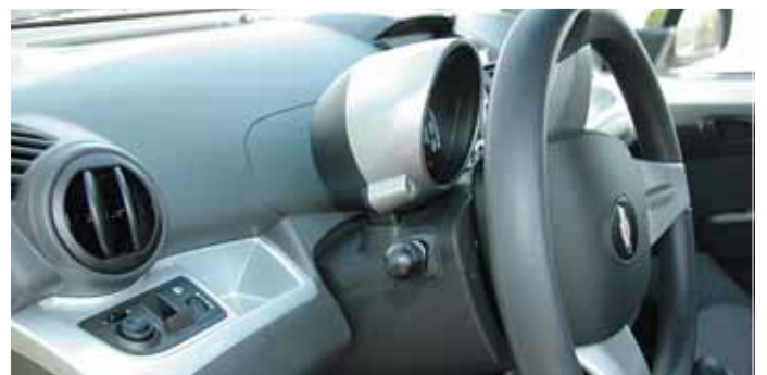
Блок приборов «прикручен» к колонке и вместе с ней двигается, слева на панели есть вы-емка для мелкой поклажи
