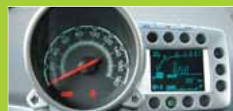
Забавный приборный щиток «мотоциклетного» типа вполне информативен, но для рослых людей его верхняя часть может перекрываться рулем
