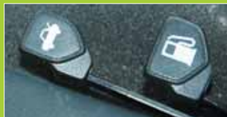
Все традиционно — лючок бака и багаж-ная дверь открываются дистанционно клавишами у кресла
