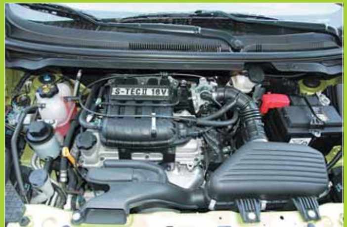
Двигатель объемом 1,2 литра мощностью 81 л.с. вполне делает машинку живой, но коробку хотелось бы более «спортивную»
