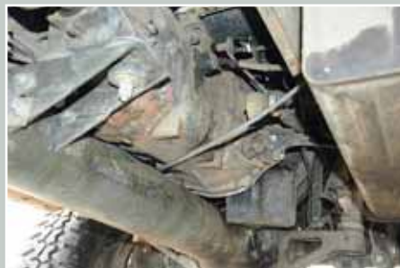
Из-за конструкции поддона и мощной хребтовой рамы двигатель удалось разместить только с некоторым осевым смещением
