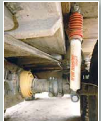
В подвеске за три года эксплуатации пока менялись только амортизаторы
