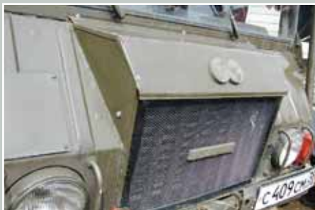
Для размещения радиатора пришлось делать стилизованный «нос»
