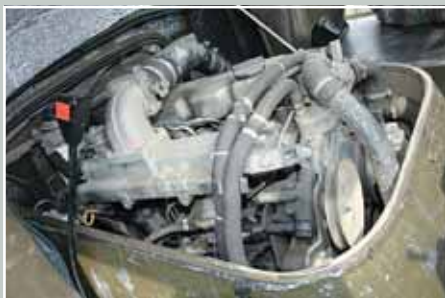
Для дизеля TD27T пришлось наращивать кожу
