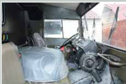
Блок рычагов управления трансмиссией с передней панели переключал на заднюю стенку, а на его месте появились отопители
