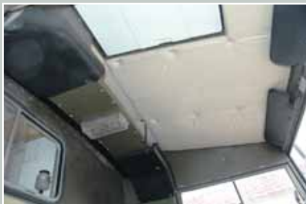
Самодельная жесткая крыша с утеплителем, люком и потолочными полками привнесла в кабину тепло, уют и функциональность
