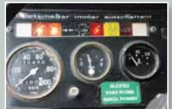
С заменой архаичного воздушника на дизель в родной приборной панели появился аналогичный по дизайну датчик температуры, от УАЗа
