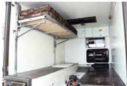
Убранство кунга осталось без изменений, разве что вместо бензинового установлен дизельный обогреватель, а наряду с пассажирскими функциями, бывшая санитарка теперь перевозит и квадроцикл
