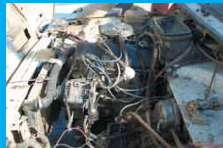
Чтобы исправить крутильный характер вазовского двигателя, был установлен распредвал с низкими кулачками
