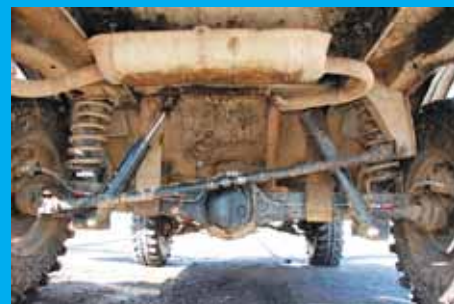
Балка моста усилена, тяга Панара разрезная, вокруг используются пружины и амортизаторы от Chevy-«Нива». Лифт сзади — порядка 2 дюймов
