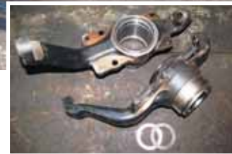
Родные поворотные кулаки протачивались под ивекоские подшипники. Это промежуточное решение — сейчас готовятся новые усиленные детали
