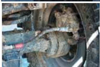
Рабочие дисковые тормоза от Suzuki Escudo, как и ступичные подшипники. Сами ступицы — оригинальные, выточенные
