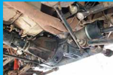
Вот как выглядит корпус переднего редуктора, будучи установленным на поперечную балку
