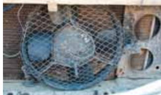
Использованы два принудительно отключаемых электровентилятора. Один расположен перед радиатором
