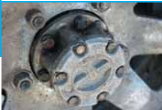
Ступичная обгонная муфта также заимствована у Escudo. Вместе с заваренным межколесным дифференциалом она играет роль его жесткой блокировки
