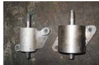
Корпус маятника выполнили из стали, ось — из стабилизатора Land Cruiser 80, подшипники японские
