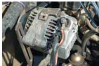
Генератор достался от 1JZ и был перенесен вверх. Основная его задача — крутить лебедку
