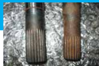
Новые задние полуоси с 26 шлицами больше тольяттинских по диаметру и выполнены из легированной стали
