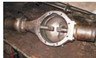
Корпус переднего редуктора — такой же как задний, только с отрезанными чулками
