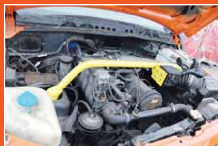
Под капотом установлена распорка, медный радиатор ВАЗ с дополнительным электровентилятором, а для АКП будет сделан масляный радиатор с интеркулером
