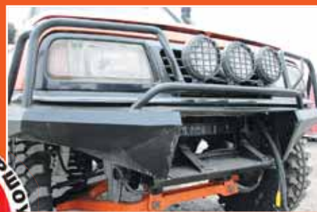
Передний мост смещен вниз на 3 см за счет самодельного подрамника, картер моста будет изготовлен из стали, а приводы для удобства ремонта будут сделаны равной длины. Передние дисковые тормоза установлены от 2,0-литрового Escudo. Изготовлена защита рулевых тяг, картеров и бака
